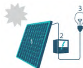
1. Zonnepaneel | 2. Omvormer | 3. Elektrische toestellen
