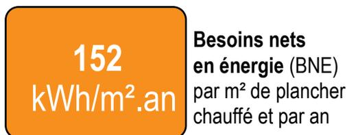
Ces besoins sont les apports de chaleur à fournir par le chauffage pour maintenir constante la température intérieure du logement. Ils dépendent des pertes par les parois selon leur niveau d'isolation thermique, des pertes par manque d'étanchéité à l'air, des pertes par la ventilation mais aussi des apports solaires et des apports internes.
