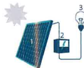
1. Zonnepaneel | 2. Omvormer | 3. Elektrische toestellen
