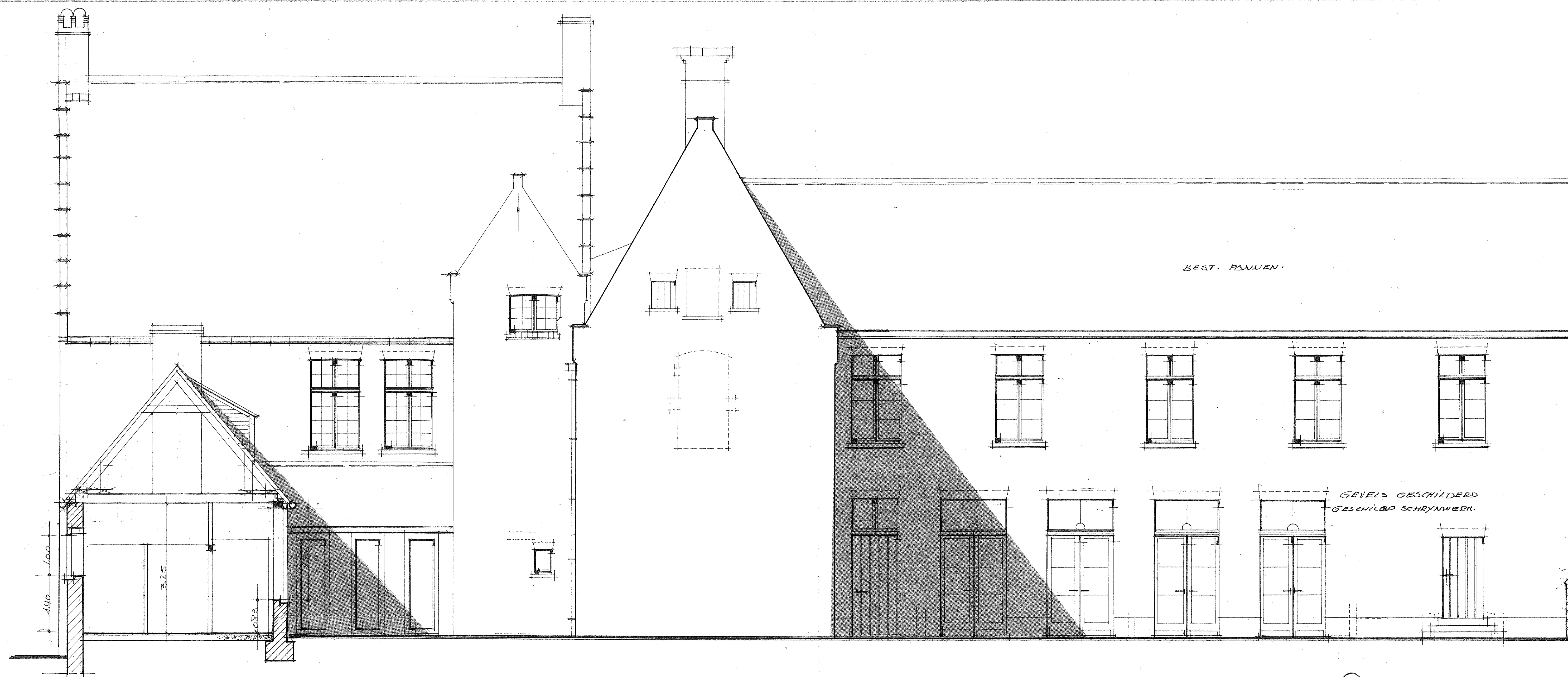
DOORSNEDE A-B ACHTERGEVEL GEBOUW STRAATKANT
