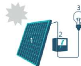
1. Zonnepaneel | 2. Omvormer | 3. Elektrische toestellen
