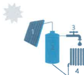
1 Zonnecollector | 2 Opslagvat zonneboiler | 3 Sanitair warm water | 4 Afgifte-element voor ruimteverwarming (radiator)
