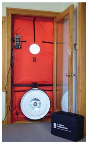
Uitvoeren van een blowerdoortest
