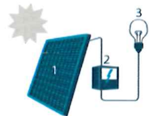
1. Zonnepaneel | 2. Omvormer | 3. Elektrische toestellen
