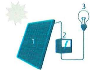
1. Zonnepaneel | 2. Omvormer | 3. Elektrische toestellen
