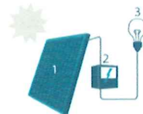
1. Zonnepaneel | 2. Omvormer | 3. Elektrische toestellen
