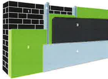
1. Buitenmuur | 2. Isolatie | 3. Vochtschermbekleding | 4. Afwerkingslaag | 5. Stijl- en regelwerk (optioneel)
