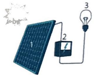
1 Zonnepaneel | 2 Omvormer | 3 Elektrische toestellen
