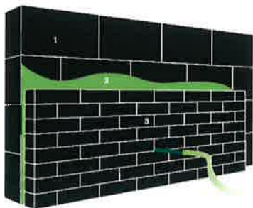
1. Dragende muur | 2. Ingeblazen isolatie | 3. Gevelsteen / gevelbekleding
