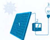
1 Zonnepaneel | 2 Omvormer 3 Elektrische toestellen
