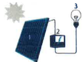
1 Zonnepaneel | 2 Omvormer 3 Elektrische aansluiting
