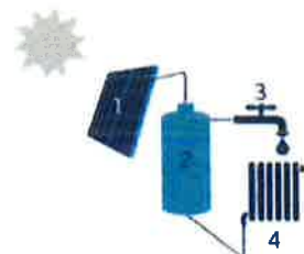
1 Zonnecollector | 2 Opslagvat voor warm water 3 Sanitair warm water aansluiting 4 Radiator
