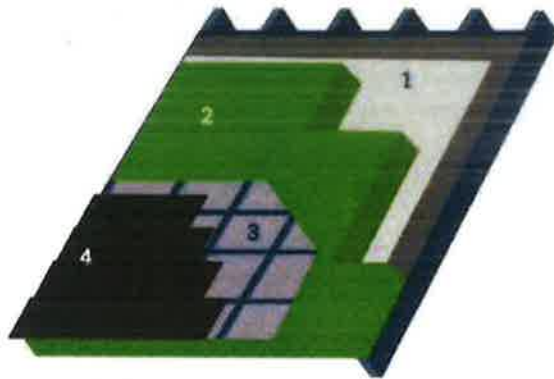
1. Dampscherm | 2. Isolatie | 3. Onderdak | 4. Dakbekleding
