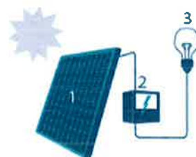
1. Zonnepaneel | 2. Omvormer | 3. Elektrische toestellen
