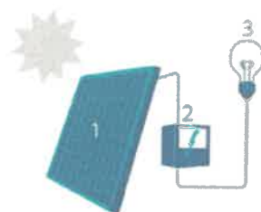
1 Zonnepaneel 2 Omvormer 3 Elektrische aansluiting
