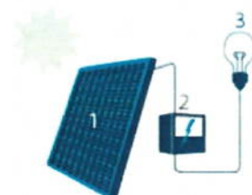
1. Zonnepaneel 2. Omvormer 3. Elektrisch verbruik
