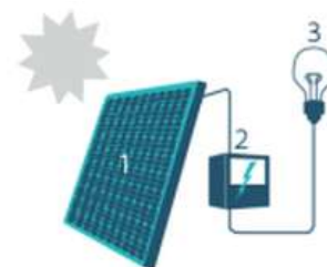
1. Zonnepaneel | 2. Omvormer | 3. Elektrische toestellen
