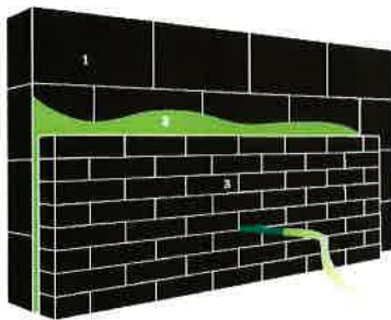
1. Dragende muur | 2. Ingeblazen isolatie | 3. Gevelsteen / gevelbekleding
