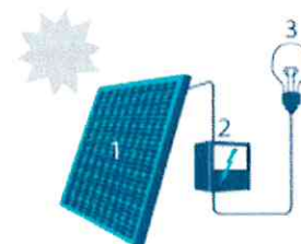
1 Zonnepaneel | 2 Omvormer | 3 Elektrische toestellen
