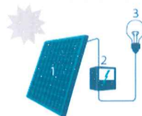
1. Zonnepaneel | 2. Omvormer 3. Elektrische toestellen
