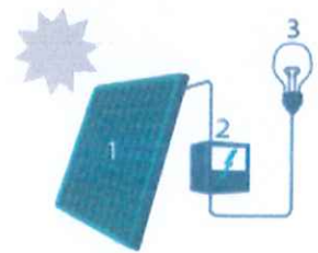
1. Zonnepaneel | 2. Omvormer | 3. Elektrische toestellen
