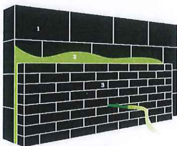
1. Dragende muur | 2. Ingeblazen isolatie | 3. Gevelsteen / gevelbekleding
