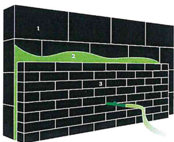
1. Dragende muur | 2. Ingeblazen isolatie | 3. Gevelsteen / gevelbekleding
