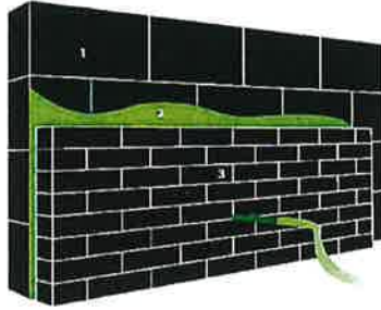
1. Dragende muur | 2. Ingeblazen isolatie | 3. Gevelsteen / gevelbekleding
