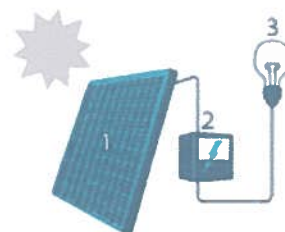
1. Zonnepaneel | 2. Omvormer 3. Elektrische toestellen
