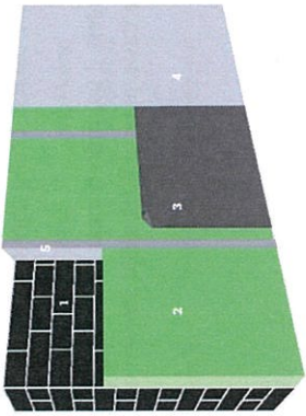
1. Buitenmuur | 2. Isolatie | 3. Vochtscherm | 4. Afwerkingslaag | 5. Stijl- en regelwerk (optioneel)
