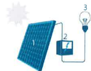
Zonnepaneel (1), Omvormer (2), Elektrische toestel (3)
