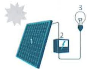
1. Zonnepaneel | 2. Omvormer | 3. Elektrische toestellen
