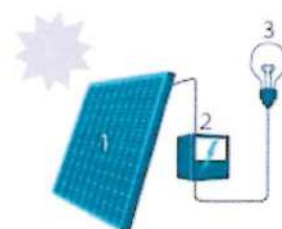
1. Zonnepaneel | 2. Omvormer 3. Elektrische toestellen
