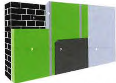
1. Buitengevel | 2. Isolatie | 3. Dampscherm | 4. Binnenafwerking | 5. Stijl- en regelwerk (optioneel)
