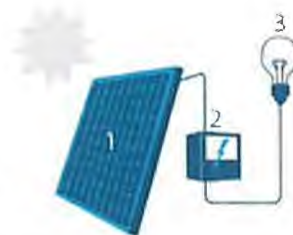
1 Zonnepaneel | 2 Omvormer | 3 Elektrische toestellen
