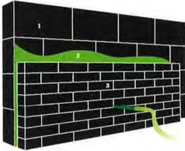
1. Dragende muur | 2. Ingeblazen isolatie | 3. Gevelsteen / gevelbekleding
