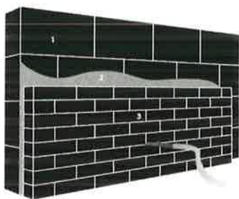
1. Dragende muur | 2. Ingeblazen isolatie | 3. Gevelsteen / gevelbekleding
