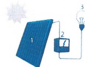
1. Fotovoltaïsch paneel | 2. Omvormer | 3. Elektrische toestellen
