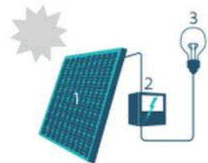
1. Zonnepaneel | 2. Omvormer | 3. Elektrische toestellen
