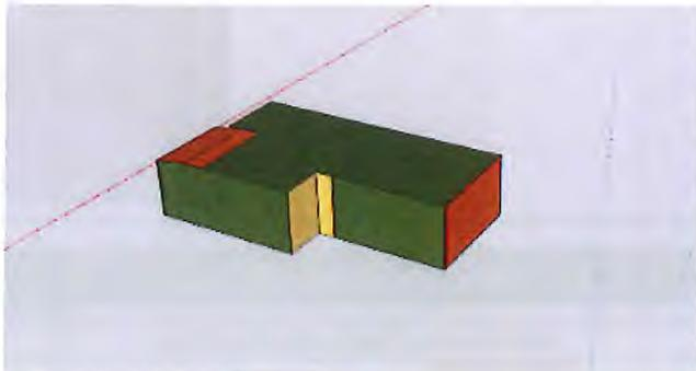
Le volume protégé d'un logement reprend tous les espaces du logement que l'on souhaite protéger des déperditions thermiques que ce soit vers l'extérieur, vers le sol ou encore des espaces non chauffés (cave, annexe, bâtiment mitoyen...). Il comprend au moins tous les locaux chauffés. Lorsqu'une paroi dispose d'un isolant thermique, elle délimite souvent le volume protégé.
